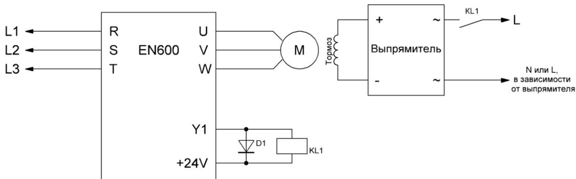
KL1 – промежуточное реле с катушкой на 24DC и максимальным током потребления более 50 мА (например: РЭК 78/4 3 А 24 В DC IEK, I<sub>кат.</sub>=37мА).
