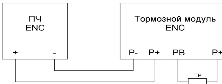
Модули имеют максимальную нагрузочную способность, т.о. при использовании с частотными преобразователями большой мощности несколько тормозных модулей меньшей мощности подключают параллельно.
