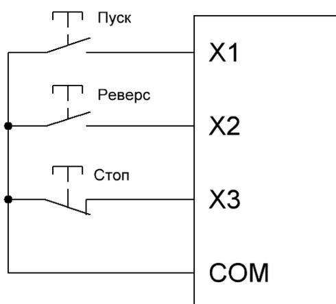
В данной схеме должны использоваться кнопки без фиксации: ПУСК, РЕВЕРС - с нормально разомкнутыми контактами, СТОП - с нормально замкнутым контактом.
