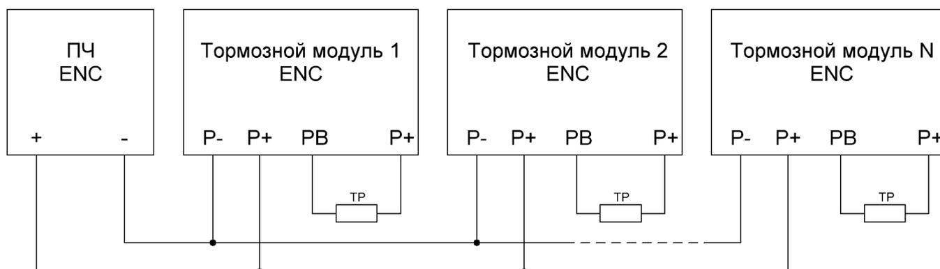
Следует учитывать, что тормозные модули требуют предварительной настройки уровня срабатывания от напряжения на шине постоянного тока и на некоторых моделях требуется установка статуса «Ведущий»/«Ведомый» при параллельном подключении нескольких модулей, в связи с этим перед включением и использованием необходимо внимательно ознакомиться с инструкцией пользователя на используемый модуль.
