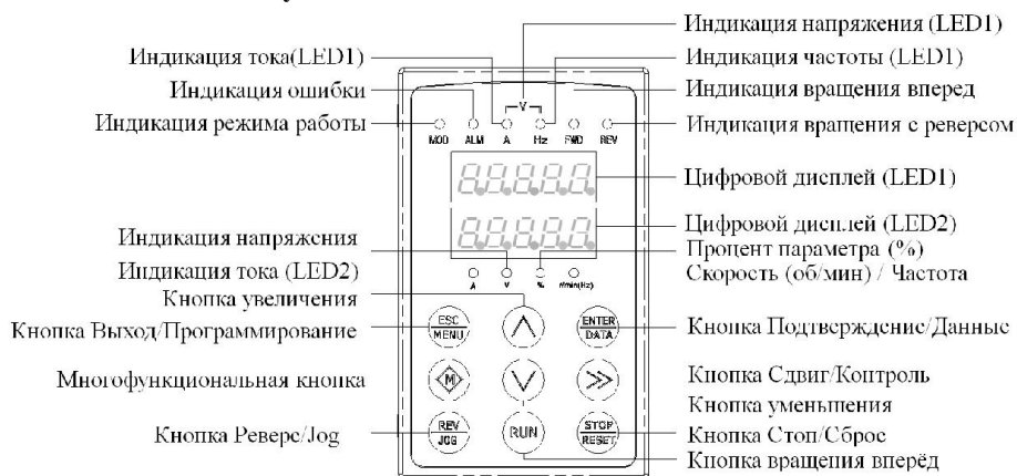
Рис.С-1 Расположение органов управления на панелиEN-LED2.
