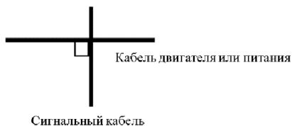
Рис.4-2 Схема пересечения проводов
