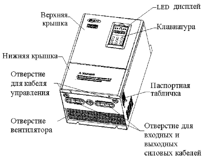
Рис.2-3 Внешний вид и наименование деталей EN600.
