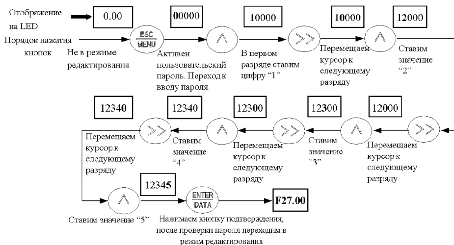
Рис.5-11 Ввод пароля для возможности изменения значений параметров
