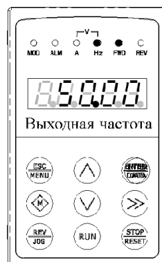
с. Режим работы, отображения частоты на выходе.
