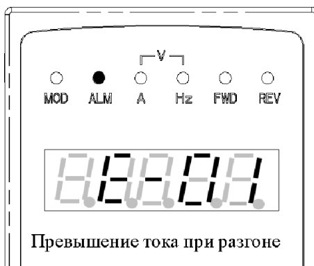
Рисунок 5-4. Отображение ошибки на дисплее.
