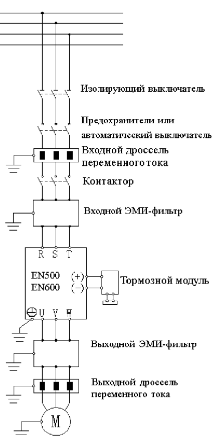
Рис.3-8 Типовое подключение преобразователя частоты.
