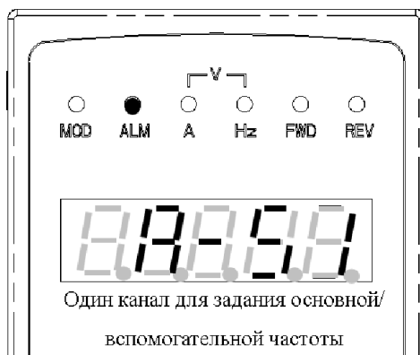
Рис.5-6 Отображение на дисплее при предупреждении.
