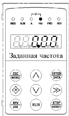
б. Режим ожидания, отображения задания частоты.
